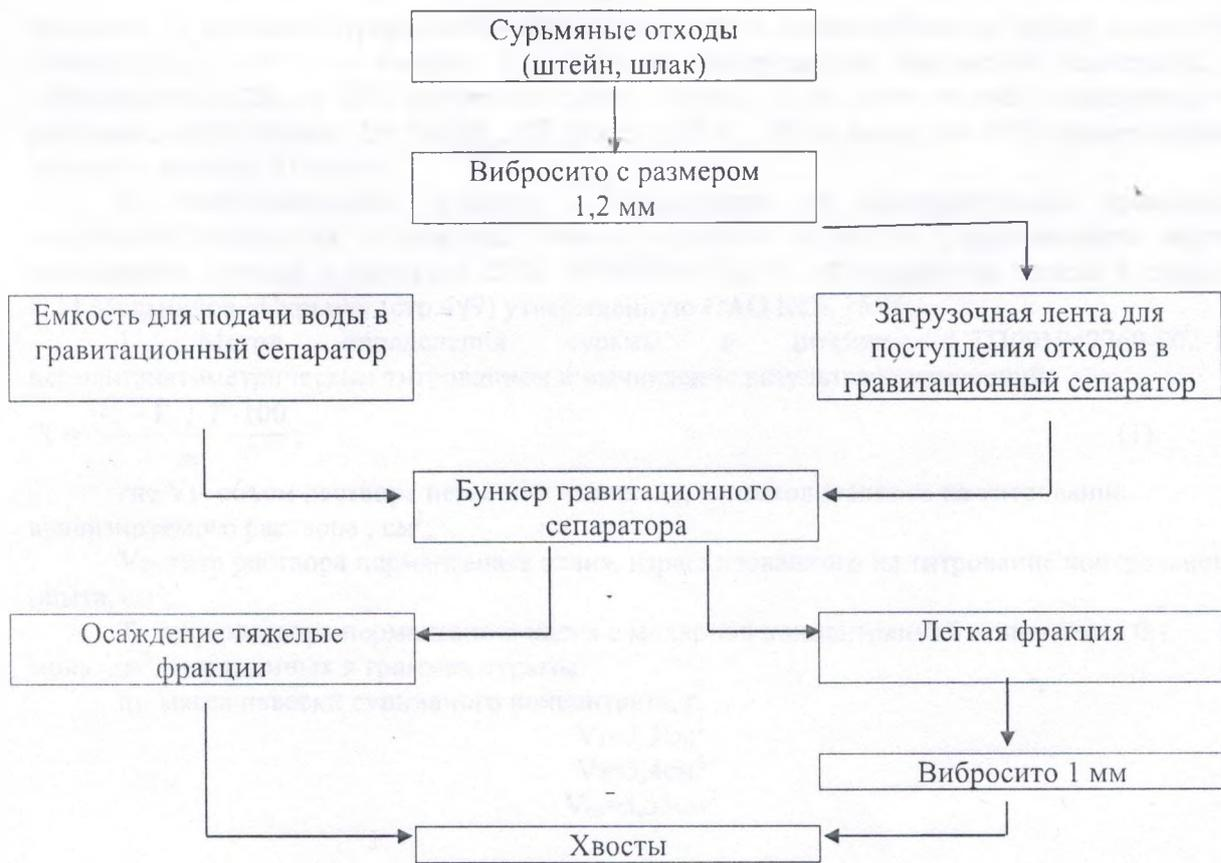
Рис. 1. Технологическая схема гравитационного сепаратора
