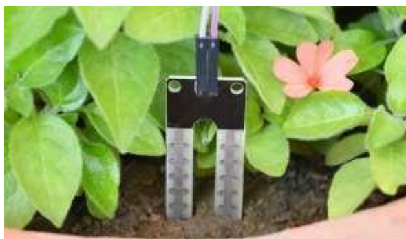
Рисунок 4. Установка датчика влажности на почву
