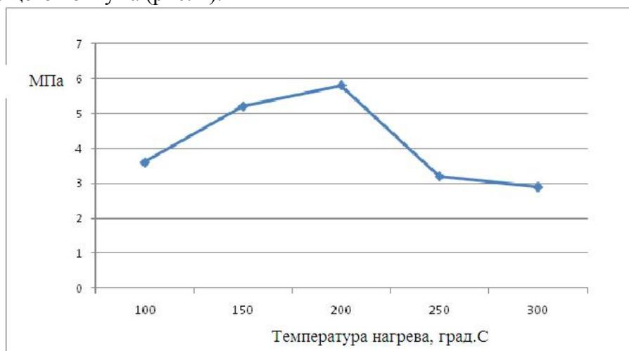
Рис. 1. Зависимость прочности брикета от температуры нагрева битума.
