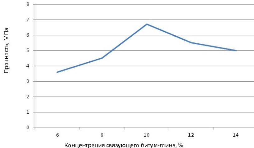
Рис. 2. Зависимость прочности брикетов от концентрации связующих битум-глина.
