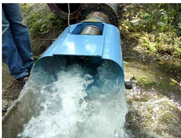
Рис.16. Бироторная микроГЭС во время испытания
