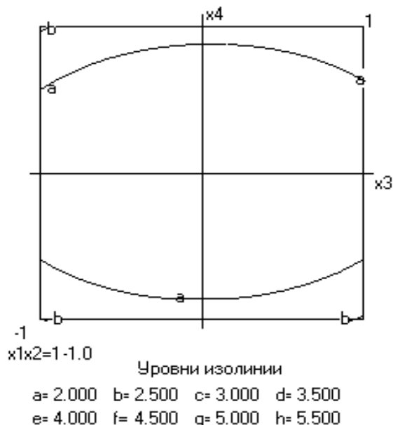
Рис. 3 ( Y_6 ). - Диэлектрическая проницаемость бездобавочного электроизоляционного материала Y_4 = f(x_3, x_4) при x_1 = -1 ; x_2 = -1 .
