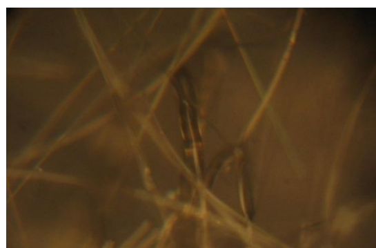
Рис.6. Микроструктура алевролитового супертонкого волокна (АСТВ), увел. ×200
